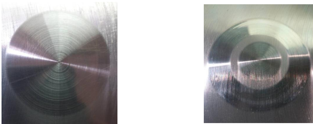
Рисунок 1 - Форми плям контакту залежно від конструкції магнітів
